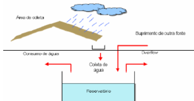
Figura 6.2- Esquema de aproveitamento de água de chuva
