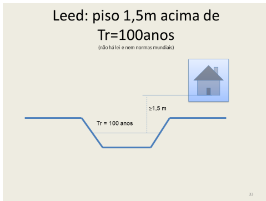
Figura 192.3- Soleira de construção
